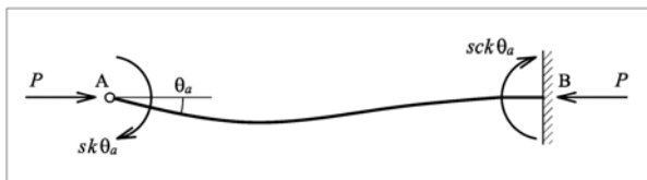
слика 2.2 Задато обртање чвора \theta_a на анализираном штапу
