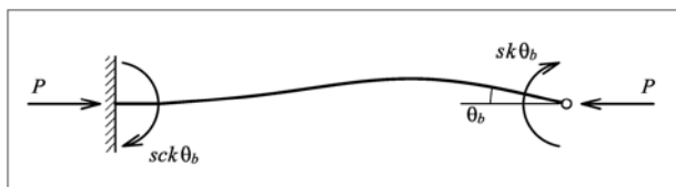
слика 2.3 Задато обртање чвора \theta_b на анализираном штапу
